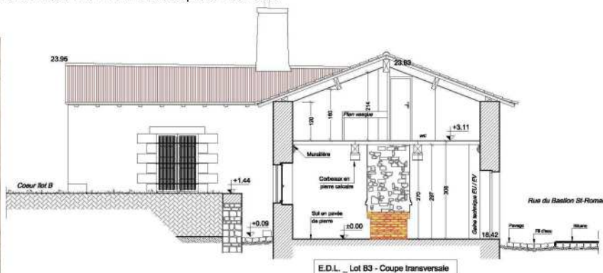
Illustration du mur de soutènement des terres laissant libre le revers pavés de récupération des eaux de pluie. Coupe schématique de l'état des lieux.
